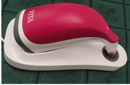
الشكل رقم (1): جهاز قياس الطيف الضوئي
