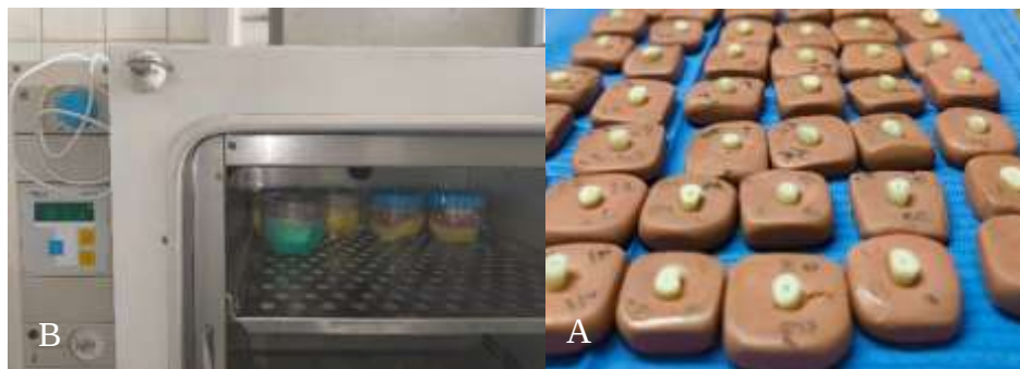
الصورة رقم 2: A. الأسطوانات العاجية في القوالب، B. العينات في الحاضنة الحرارية (الباحث)
