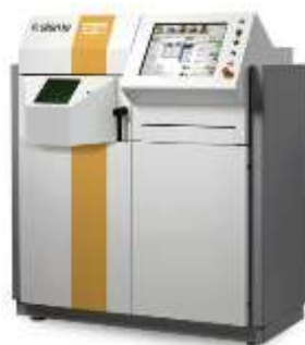
الشكل رقم (4) الطباعة ثلاثية الأبعاد المستخدمة في تصنيع القلوب والأوتاد المعدنية
