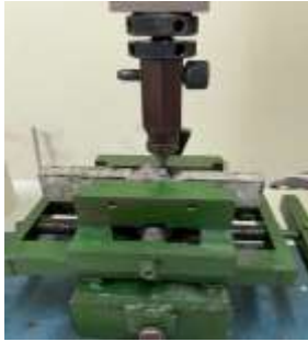
الشكل رقم (6) جهاز الاختبارات العام لتطبيق قوى الضغط
