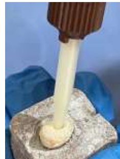
الشكل رقم (5) اللصاق بالاسمنت الراتنجي
