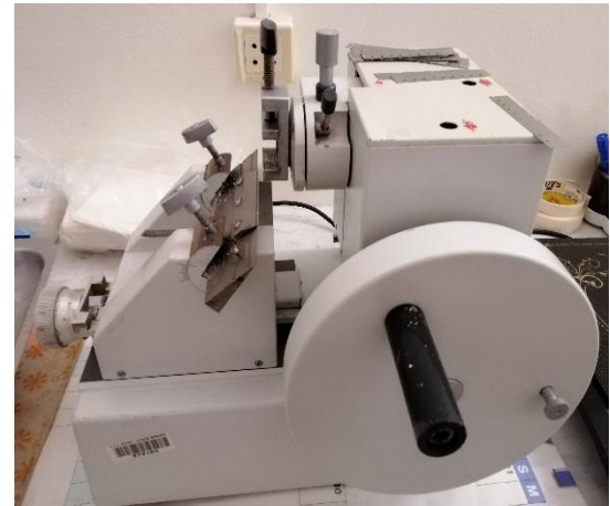
الشكل (24): جهاز التقطيع (المقطع الدائري اليدوي microtome roxary)
