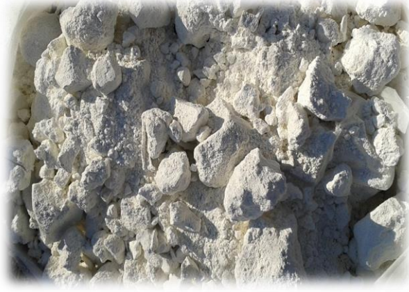
الصورة (١٥): أحجار الكلس الحي المستخدم في التجربة
