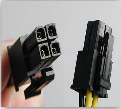
وهو عبارة عن ٤ خطوط ويستخدم لإمداد المعالج بالطاقة. يجب استخدام هذا الموصل لكل اللوحات إلا إذا كانت تستخدم موصل EPS12V، هذا الموصل نظريا يستطيع امداد المعالج بطاقة تصل حتى ١٩٢ واط .
