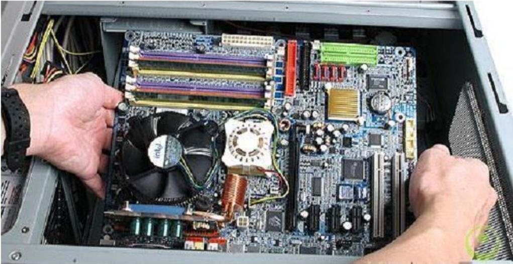
سابعاً: توصيل اللوحة الام مع مزود الطاقة و الكهرباء
