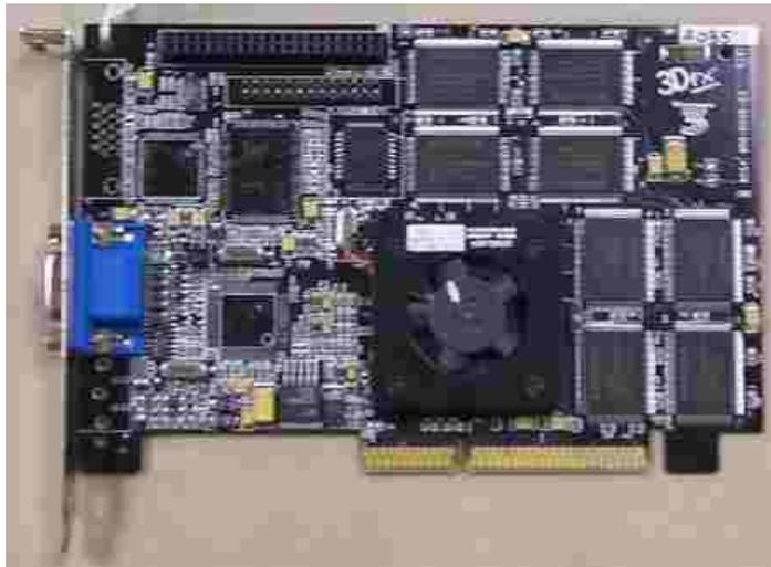
هل لاحظت وجود مروحة التبريد على البطاقة ؟ هذا لأن المسرع الرسومي ينتج الكثير من الحرارة لذا فإن درجة حرارته ترتفع كثيراً مما أضطر الشركة المصنعة لاستخدام المروحة لتبريده ،لم تكن بطاقات الفيديو المنتشرة على مدى السنوات السابقة تحتاج لتبريد ، لكن يبدو أنه مع ازدياد حاجتنا لقوة معالجة فإن المراوح ستصبح شيئاً اعتيادياً في البطاقات الرسومية كما أصبحت مع المعالجات المركزية منذ سنوات .
