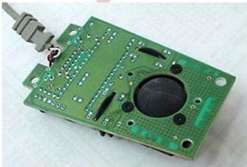
للفأرة كابل يوصلها إلى الحاسب ولهذا الكابل نهاية توصيل تكون من النوع Serial Connector أو PS/2 Connector. وهذا الكابل يقيم بمهمة
