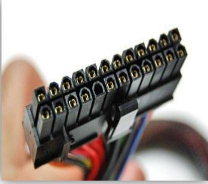
وهو عبارة عن ٢٤ خط وقد يسمى ٢٠ + ٤ لأن آخر ٤ أخطوط يمكن ازالتهم لاستخدامه في اللوحات الأم التي تستخدم ٢٠ خط، واللوحات الأم التي تستخدم ٢٤ خط تسمى ATX12V 2.x أما اللوحات الأم التي تستخدم ٢٠ خط فقط تسمى ATX12V 1.x.
