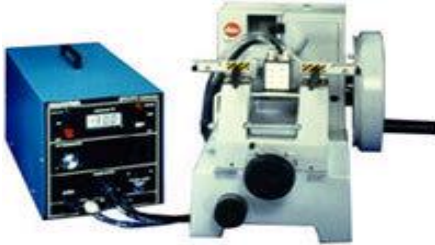
الشكل (10-2) ميكروتوم التجميد بغاز ثاني أكسيد الكربون
