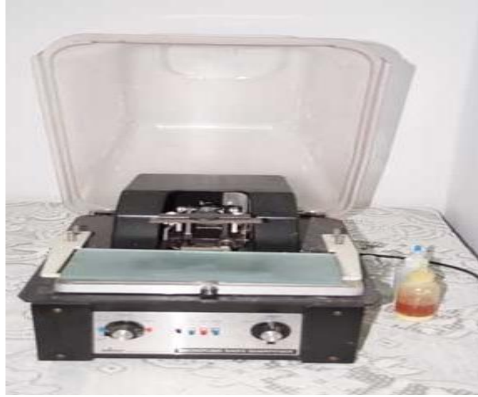
شكل (2-8) جهاز سن سكين الميكروتوم
