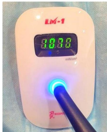
الشكل 20: التأكد من الانبعاث الإشعاعي لجهاز التصليب الضوئي.
