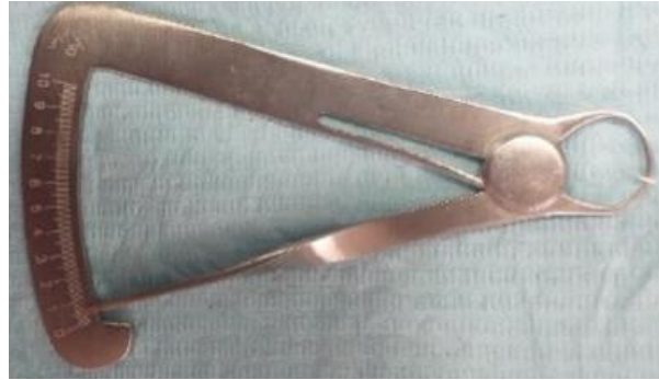
الشكل 18: التأكد من ثخانة الشرائح العاجية بواسطة مقياس السماكة.
