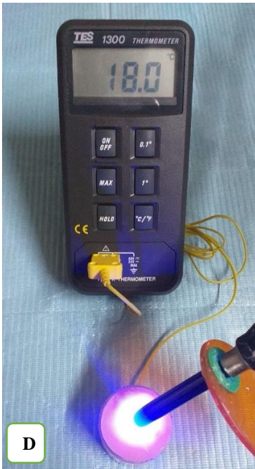
الشكل 21: طريقة قياس ارتفاع درجة الحرارة.
