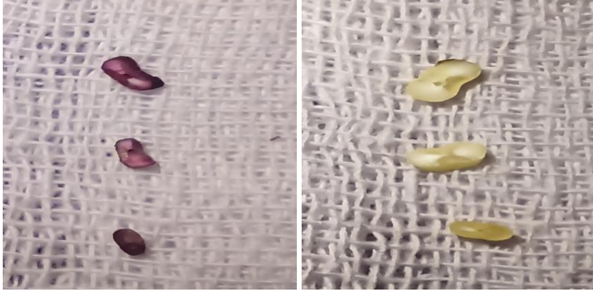
الشكل (30-3): يوضح المقاطع العرضية الثلاث قبل غمرهم في الصباغ وبعد غمرهم فيه.
