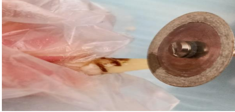
الشكل (3-28): إجراء المقاطع العرضية باستخدام القرص الماسي.
