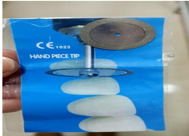
الشكل (3-15): الأقراص الماسية المستخدمة في عمل المقاطع الأفقية.
