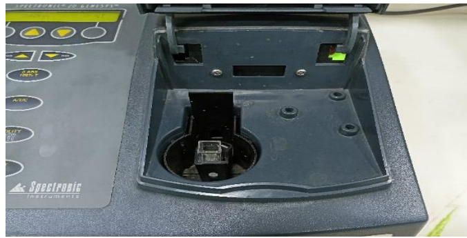
الشكل (27-3): يظهر الحجرة التي يوضع فيها أنبوب كيوبيت.
