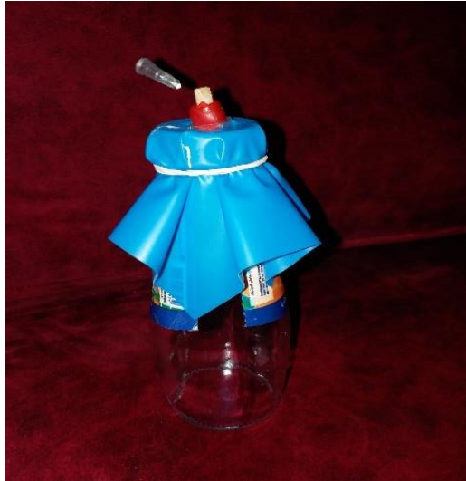
الشكل (3-19): جهاز جمع البقايا المتجاوزة ذروياً يدوي الصنع.
