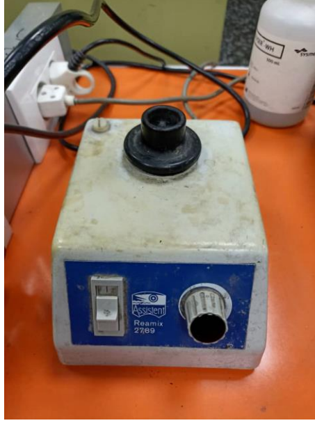
الشكل (3-14): جهاز لهز أنابيب كيوفيت قبل القياس
