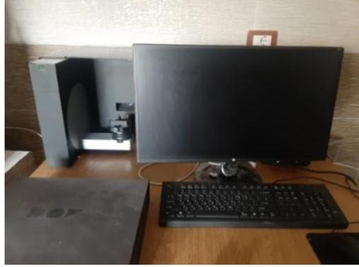
الشكل (17) الماسح الضوئي والحاسوب الخاص بجهاز CAD/CAM
