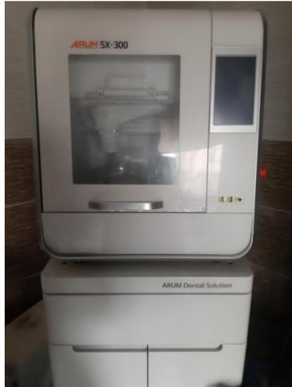
الشكل (18) جهاز التفريز الخاص بجهاز CAD/CAM
