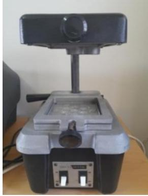
الشكل (15) جهاز التخلية الهوائية
