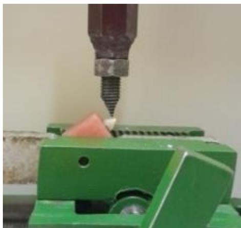
الشكل (49) اختبار قوة الكسر لإحدى العينات
