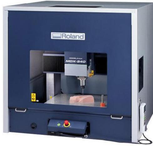
الشكل (2) آلة الخراطة المنضدية (A Tabletop milling machine).
