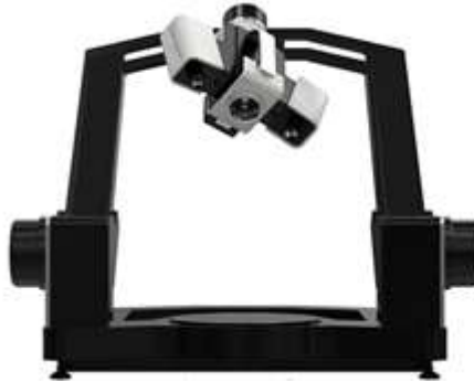
الشكل 2 الماسح الضوئي المرتب الثلاثي الأبعاد ( Ohno, Kawahara ) (et al. 2009)
