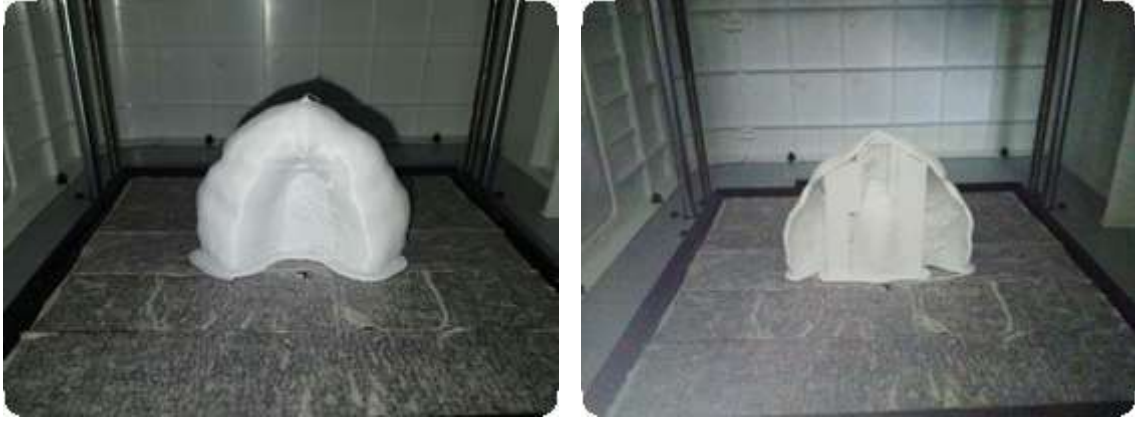
الشكل 30 وضع الطابع اثناء الطباعة
