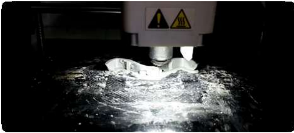
الشكل 30 وضع الطابع اثناء الطباعة
