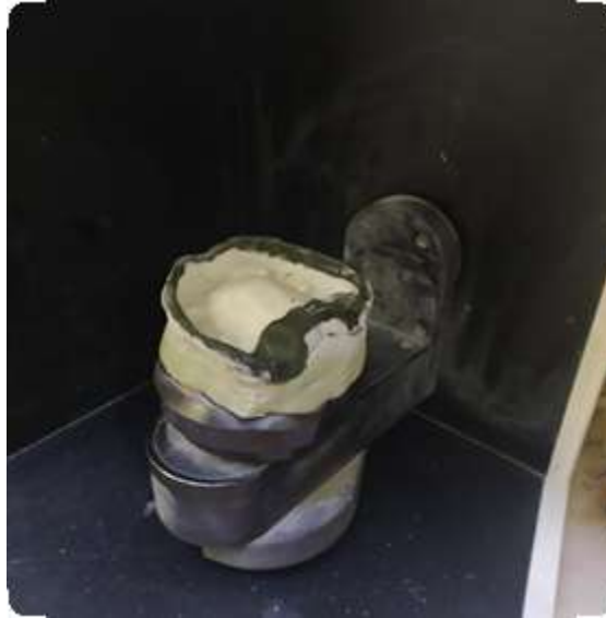
الشكل 38 يوضح طريقة تثبيت الطابع على الجهاز الماسح
