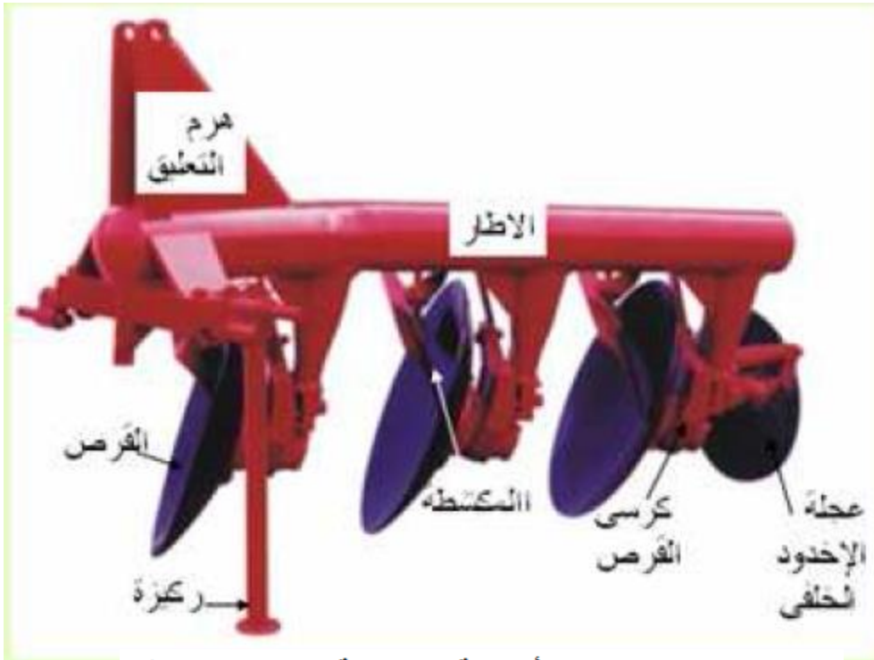
شكل ( 2 ) المكونات الأساسية لمحراث قرصى ٣ بدن معلق
