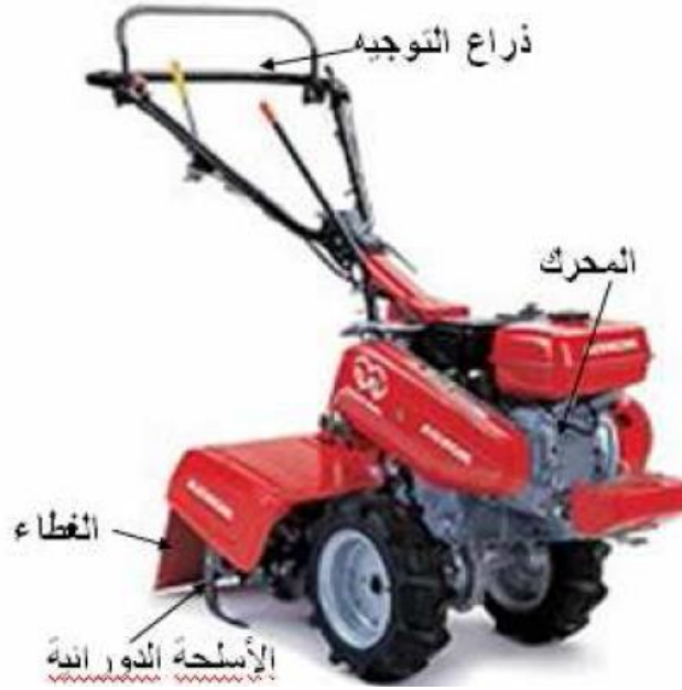
شكل ( 3 ) الأجزاء الرئيسية لمحراث دورانى يوجه باليد
