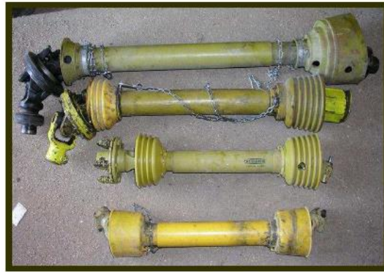
شكل (١٧): اشكال مختلفة للوصلات المرنة
