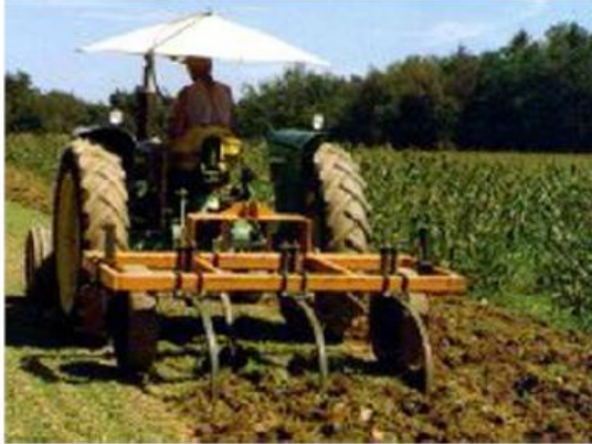
شكل ( ٤٣ ) محراث حفار ٥ سلاح أثناء التشغيل
