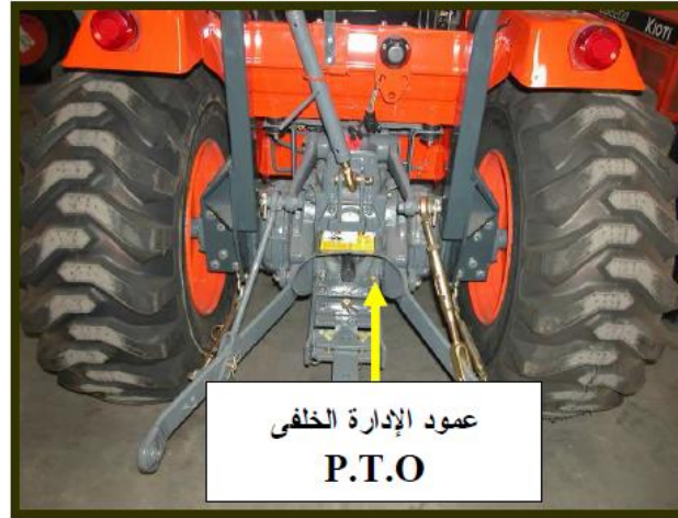
شكل (١٦): منظر خلفي للجرار يظهر فيه عمود الإدارة الخلفي
