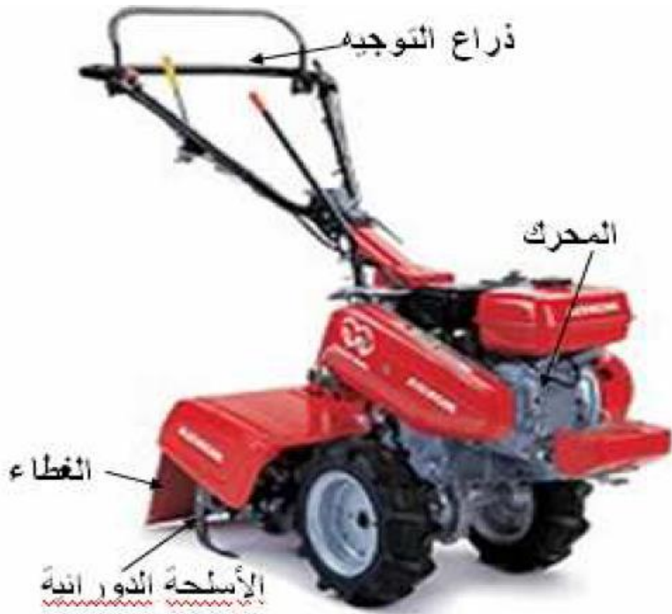
الشكل (٣) الاجزاء الرئيسية لمحراث دوراني يوجه باليد
