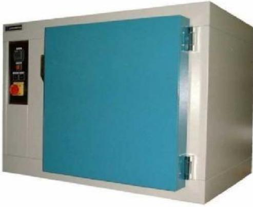
يستند مبدأ هذه الطريقة إلى رفع درجة حرارة الهواء الموجود داخل الأفران وضبط هذه الدرجة بالمنظم الحراري (الترموستات) على أن تبقى ثابتة طيلة مدة التعقيم. تعقم بهذه الأفران جميع الأدوات المعدنية والزجاجية بعد لفها وتهيتها لمنع تلوثها أو وضعها في علب معدنية، ودرجة الحرارة المستعملة في تعقيم هذه الأدوات هي 180°م لمدة نصف ساعة، أما الأدوات
