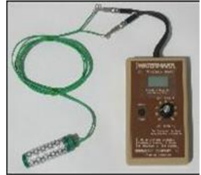
الشكل (6-9): يوضح أنواع من أجهزة قياس الرطوبة باستخدام قالب الجبس من نموذج Bouyoucos المزود بمقياس الرطوبة
