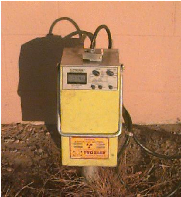
شكل (6-5): يوضح صور المجس وجهاز تقدير رطوبة التربة بطريقة تشتت النيوترونات
