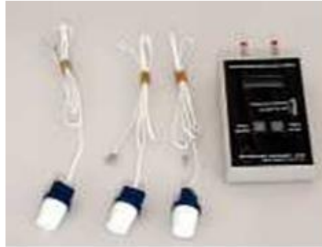
الشكل (6-9): يوضح أنواع من أجهزة قياس الرطوبة باستخدام قالب الجبس من نموذج Bouyoucos المزود بمقياس الرطوبة
