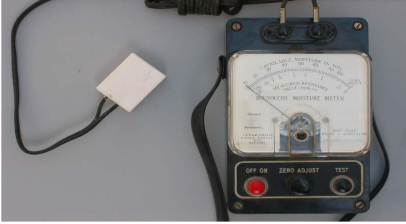
الشكل رقم (6-8): أنواع من أجهزة قياس الرطوبة باستخدام قالب الجبس من نموذج Bouyoucos المزود بمقياس الرطوبة
