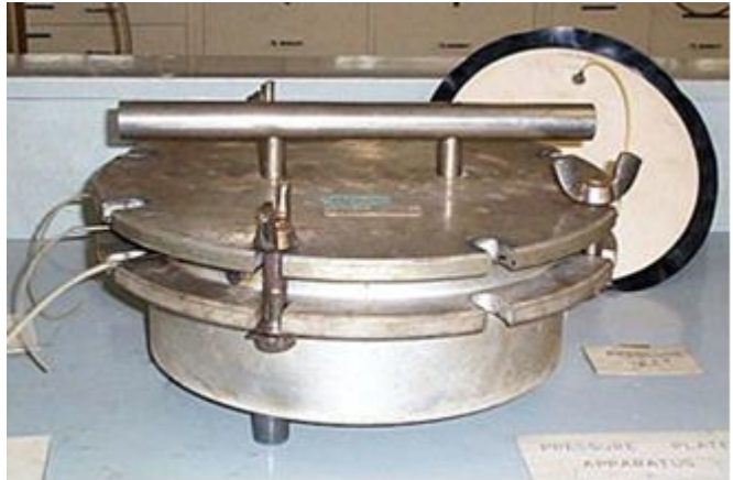
شكل (6-13): جهاز القرص المسامي لتقدير منحنى الشد الرطوبي
