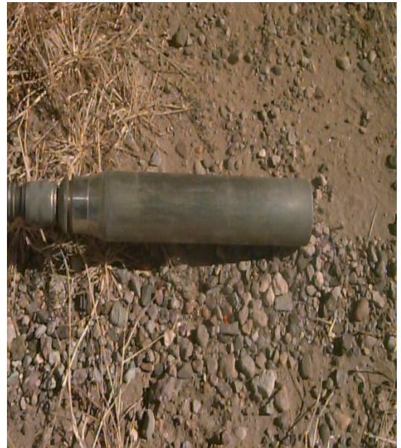
شكل (6-5): يوضح صور المجس وجهاز تقدير رطوبة التربة بطريقة تشتت النيوترونات
