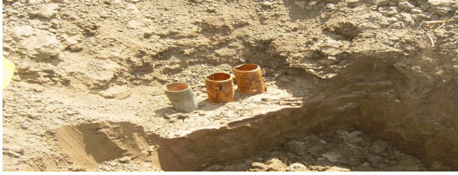
الشكل رقم ( 4-4 ): يوضح كيفية أخذ عينات التربة بطريقة الاسطوانة لتقدير الكثافة الظاهرية من الطبقة تحت السطحية
