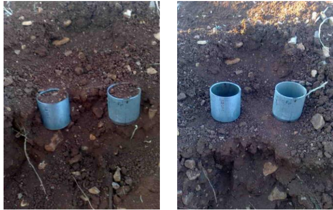
الشكل رقم ( 3-4 ) طريقة الاسطوانة لتقدير الكثافة الظاهرية
