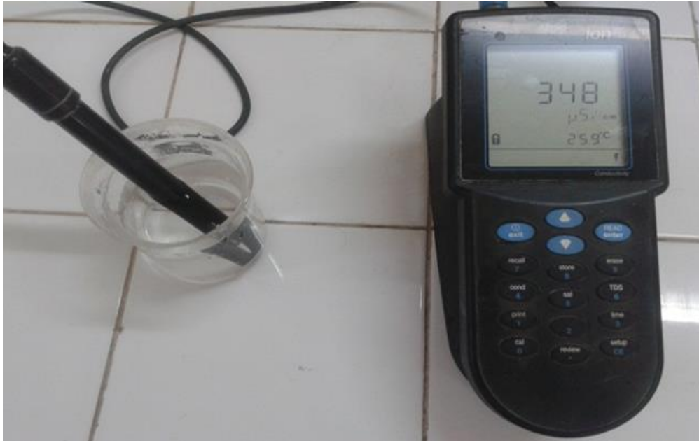
الشكل ١٠ : جهاز قياس الناقلية الكهربائية ودرجة الحرارة ومجموع الأملاح الذائبة
