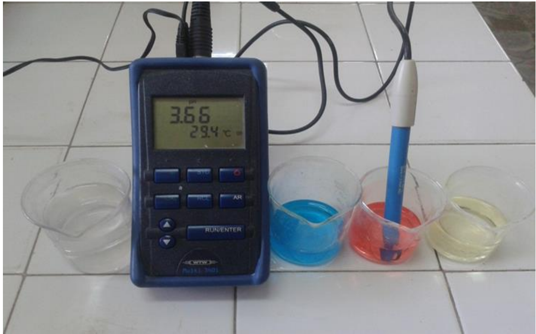
الشكل ١١ : جهاز قياس درجة الأس الهيدروجيني (pH-meter)
