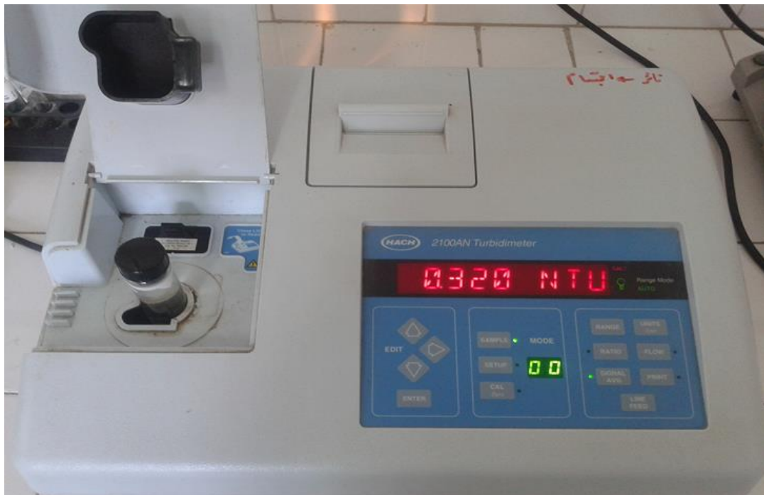
الشكل ١٢ : جهاز قياس العكارة (Turbidity meter)
