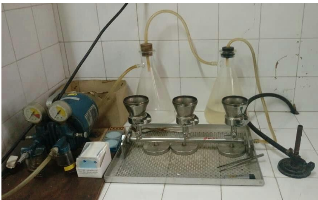
الشكل ٢١: جهاز الترشيح المستخدم في الفحص الجرثومي لعينات المياه
