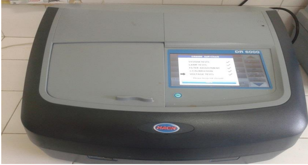
الشكل ٩ : جهاز المطياف الضوئي لقياس (النترات، النتريت، الكبريتات، الأمونيا، الحديد)
