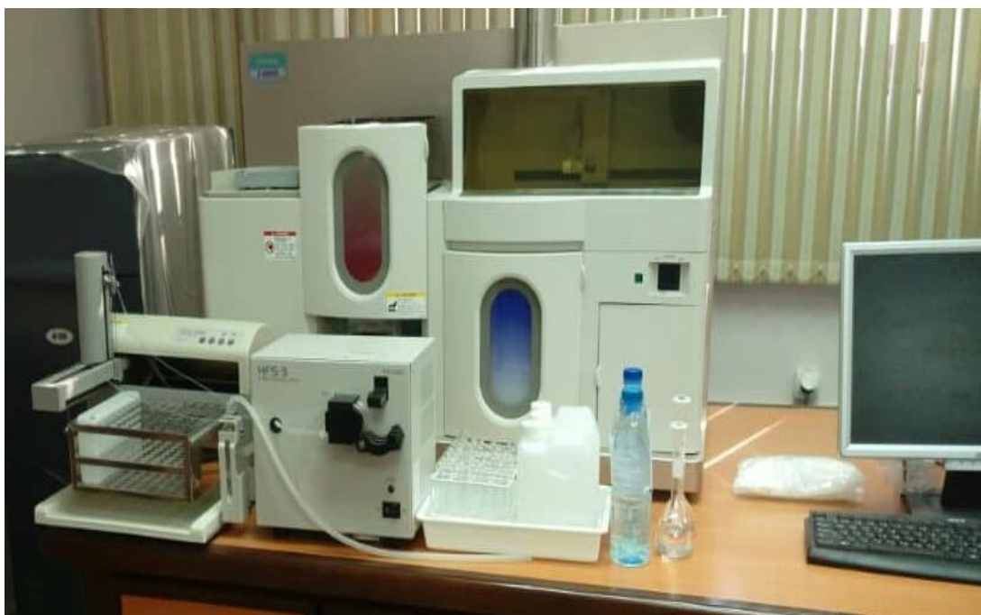
الشكل ٢٠: جهاز الامتصاص الذري لقياس تركيز المعادن الثقيلة (الرصاص، الكاديوم)
