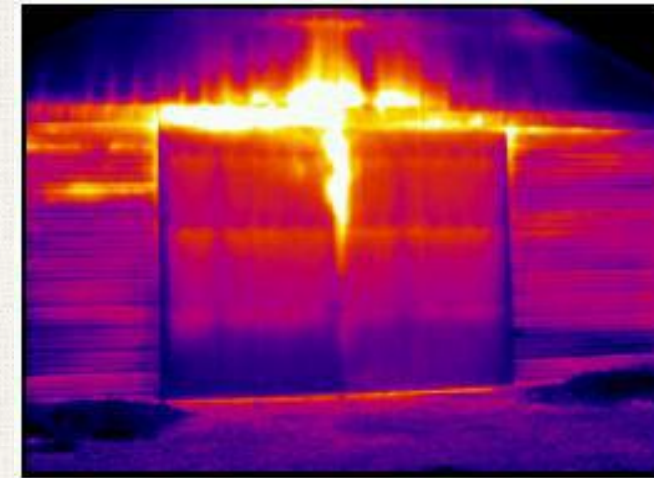
تسرب الهواء الدافئ من شقوق باب الحظيرة
