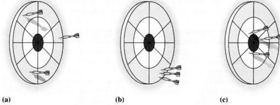
الشكل (1 - 4) صحة ودقة القياس. (a) دقة ضعيفة وصحة ضعيفة (b) دقة عالية وصحة ضعيفة (c) دقة ضعيفة وصحة قياس مرتفعة
