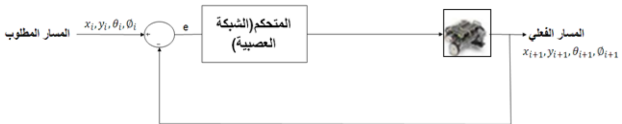
الشكل رقم (4): نظام التحكم بمسار العربة الأرضية المستقلة باستخدام الشبكة العصبونية.
