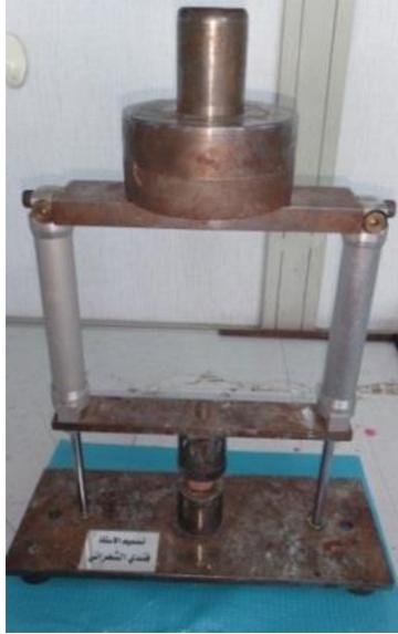
الشكل رقم (7): جهاز توحيد الضغط
