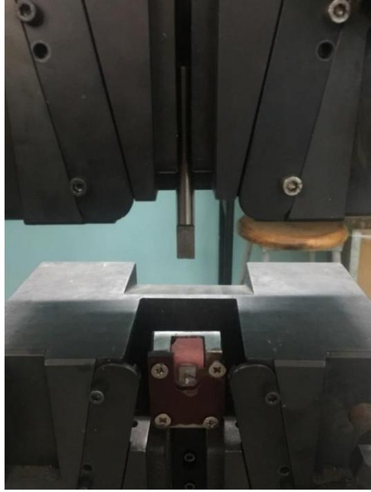
الشكل رقم (7): جهاز القص المستخدم
