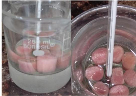
الشكل رقم (3): العينات داخل المحلول الحمضي (H<sub>2</sub>SO<sub>4</sub>+HCl) مع الحفاظ على درجة حرارة 70 درجة مئوية أثناء التخریش.
