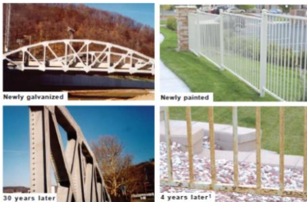
الشكل رقم (4): مقارنة بين الفولاذ المغلفن بالزنك لحار والمطلي بالدهان حديثاً وبعد مرور الزمن [3]
