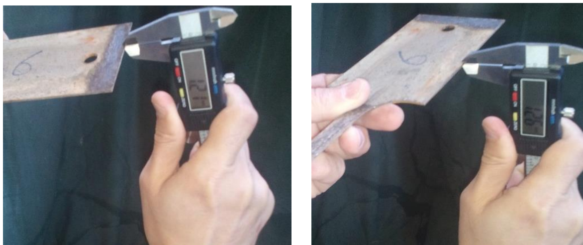
الشكل رقم (7): يوضح إختلاف سماكة العينات الخامية قبل وبعد الغمر نتيجة تشكل الصدأ
