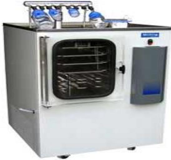
شكل (2-16) جهاز تجفيف اللقاحات بالتبريد
