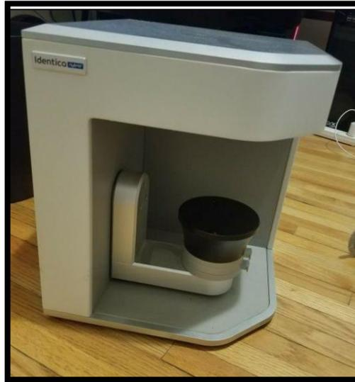
الشكل (16) جهاز المسح الرقمي المخبري
