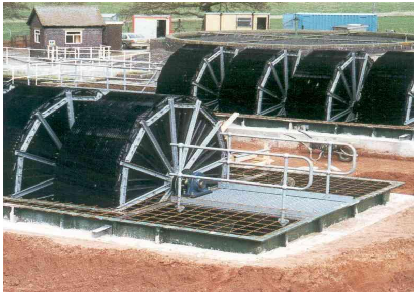
الشكل (6-7): مرشحات بيولوجية ذات الأقراص الدوارة بمراحل متعددة
