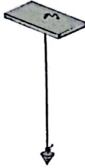
الشكل (3-9) الشاقول - ثقل مخروطي بطرف الخيط
