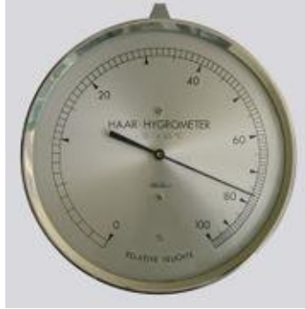
الشكل (٧-٣): مقياس الرطوبة النسبية ذو الشعرة
