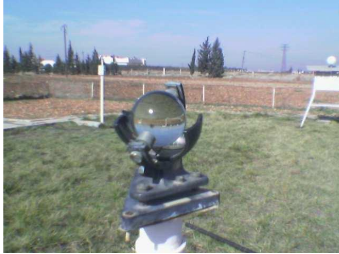
الشكل (٢-٢): مسجل مدة السطوع الشمسي نموذج كامبل ستوكس في المحطة المناخية الخاصة بمحطة بحوث الري في المختارية بحمص
