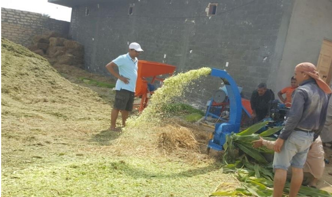
الشكل (1): عملية سحق بقايا المحاصيل الخضراء بعد حشها يدوياً وتجميعها.
