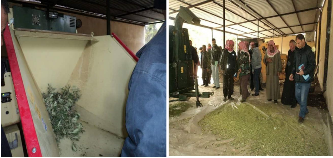
الشكل (3): عملية سحق نواتج تقليم الزيتون باستخدام فرامة مخصصة لهذا الغرض.
