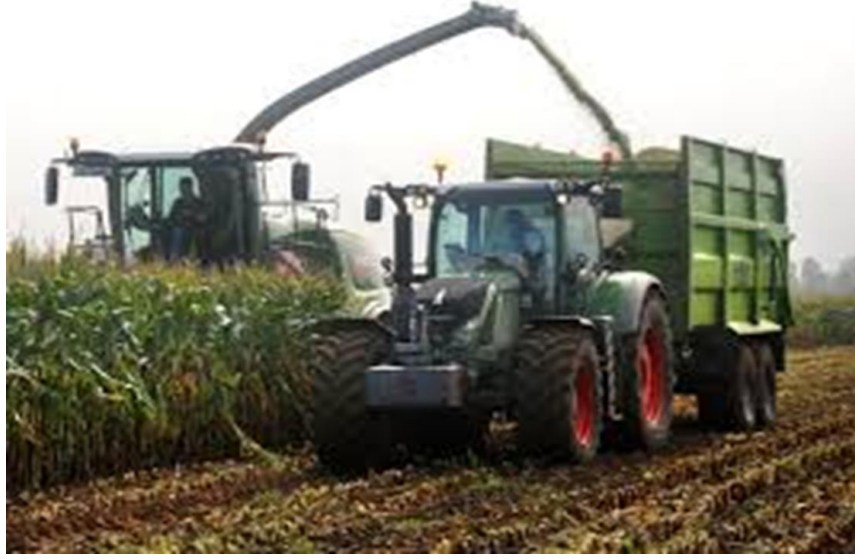
الشكل (2): الجمع والفرم الآلي لمخلفات المحاصيل الزراعية مباشرة في الحقل.
