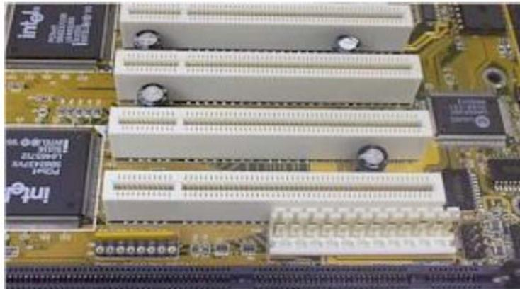
شكل رقم (30) صورة ناقل من النوع PCI
