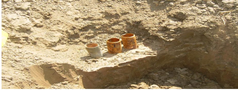
الشكل رقم ( ٤-٤ ) : يوضح كيفية أخذ عينات التربة بطريقة الاسطوانة لتقدير الكثافة الظاهرية من الطبقة تحت السطحية
