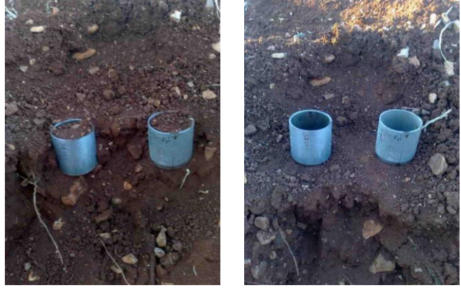
الشكل رقم ( ٣-٤ ) طريقة الاسطوانة لتقدير الكثافة الظاهرية
