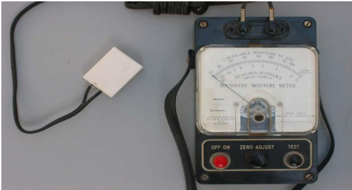
الشكل رقم (٦-٨): أنواع من أجهزة قياس الرطوبة باستخدام قالب الجبس من نموذج Bouyoucos المزود بمقياس الرطوبة
