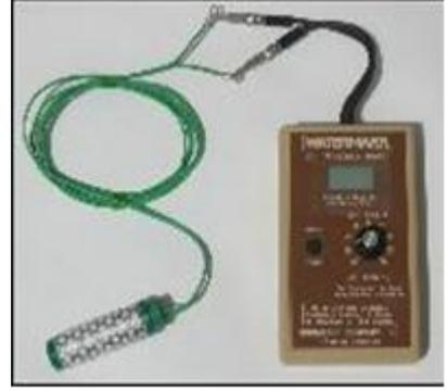
الشكل (٦-٩): يوضح أنواع من أجهزة قياس الرطوبة باستخدام قالب الجبس من نموذج Bouyoucos المزود بمقياس الرطوبة
