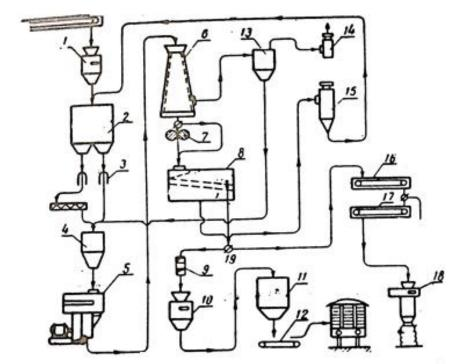
۱- میزان -۲- خزان -۳- مغناطیس -۶- میزان -۰- وحدة التحبیب -۲- مبرد -۷- جاروشه -۸- غرابیل -۹- ناقصل ۱۰- میز ن -۱۱- خزان -۱۲- ناقل -۱۳- خوان -۱۶- مروحه ۱۰- خزان -۱۱- ناقل - ۸۱- جهاز وزن آلي
