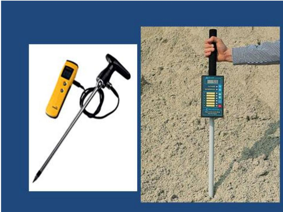
الشكل رقم (5): جهاز التشتت النثروني
