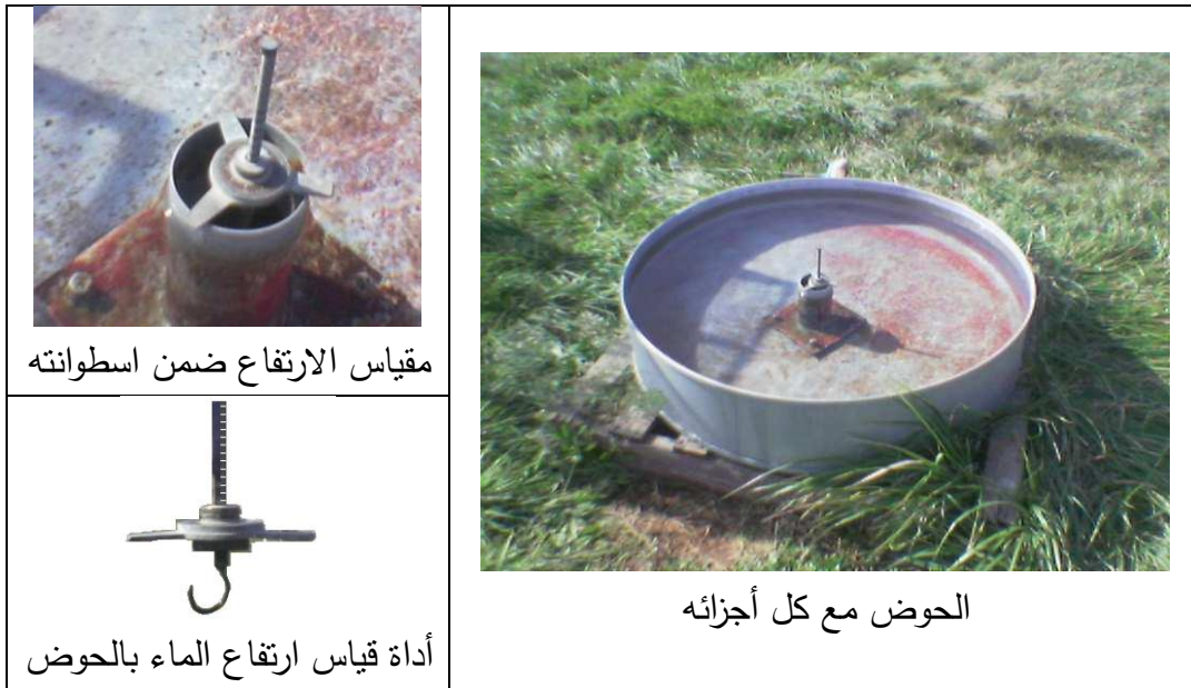
الشكل (2) حوض التبخر نموذج A (Class-A)
