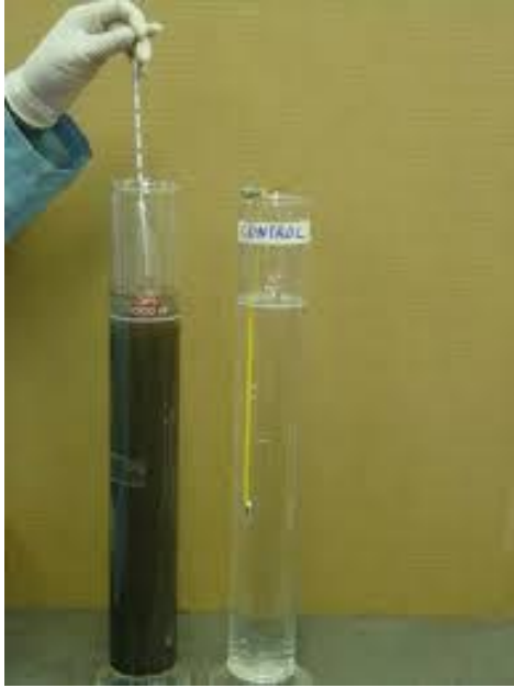
الشكل (رقم 1) هيدرومتر التربة واستخدامه
